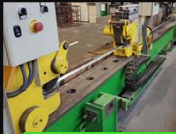
Widok profilu poddawanego dodatkowemu procesowi rozciągania „na zimno”
