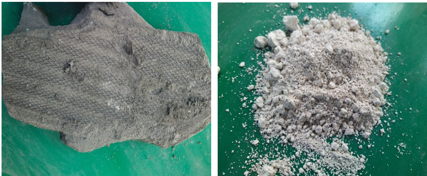
Rysunek 3 Zdjęcia wsadu pozostałości potugowniczej zawierającej siarczan ołowiu (lewa) i uzyskanego węglanowego koncentratu ołowiu (prawa)
